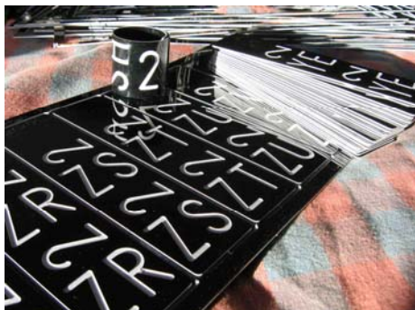
Halsbanden komen als plaatjes uit de graveermachine, waarna ze in kokend water gekruild kunnen worden.
